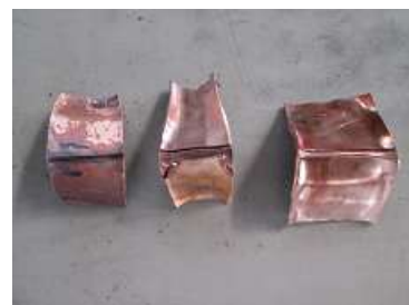
ろう付部を切断し内側評価
